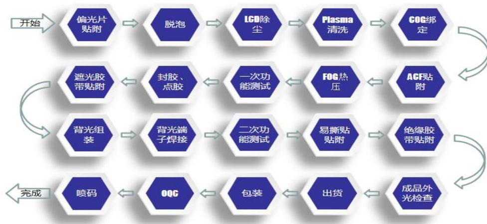
图 3-1 生产工艺流程图
